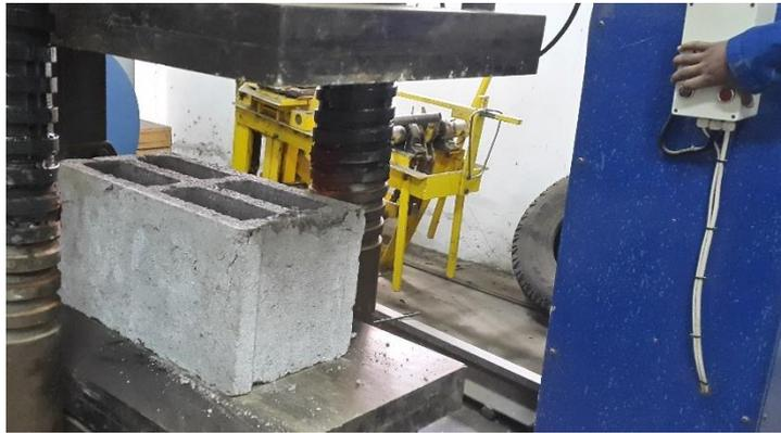
**Figura 15: Corpo de prova posicionado para o ensaio de compressão**
