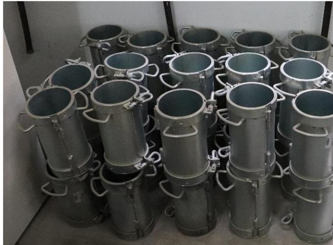
**Figura 9: Moldes para provetes cilíndricos (LEM, IP)**
