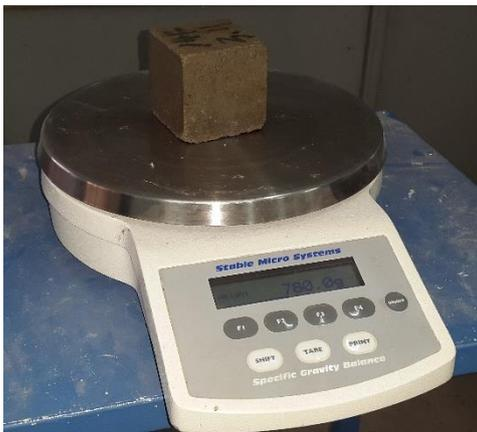
**Figura 12: Medição da massa do provete na balança electrónica**
