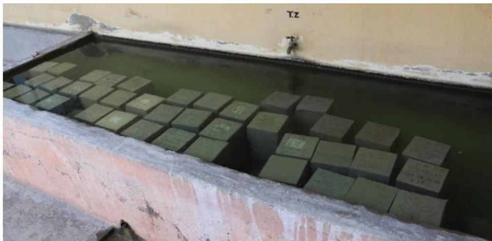
**Figura 10: Cubos de betão imersos no tanque de cura (LEM, IP)**
