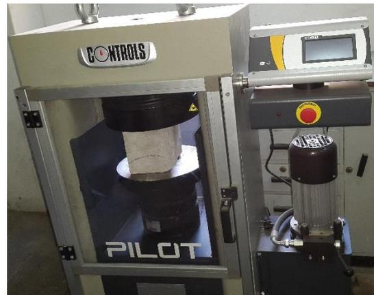
**Figura 13: Compressão uniaxial do provete cúbico de betão**
