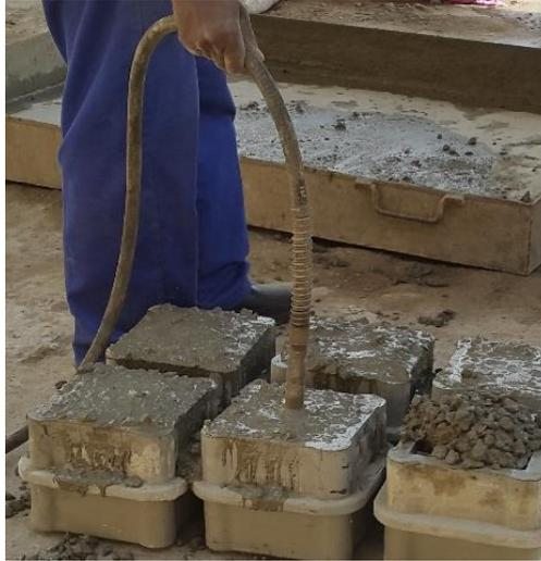
**Figura 11: Compactação do betão em moldes cúbicos por meio de uma agulha vibradora**
