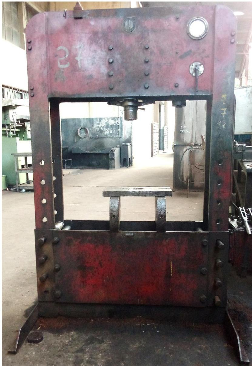
Figura 19. Prensa hidráulica HIAB da Ermoto. (fonte: Autor)
