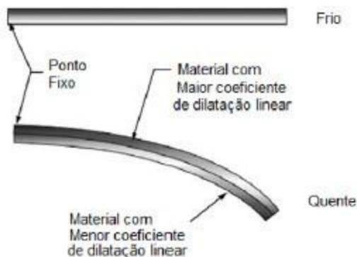
**Figura 10.** Princípio de funcionamento do relé térmico. **Fonte:** Maurício Taques
