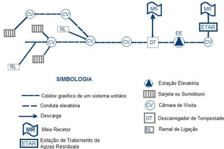
Figura 3: Representação esquemática de um sistema unitário.
