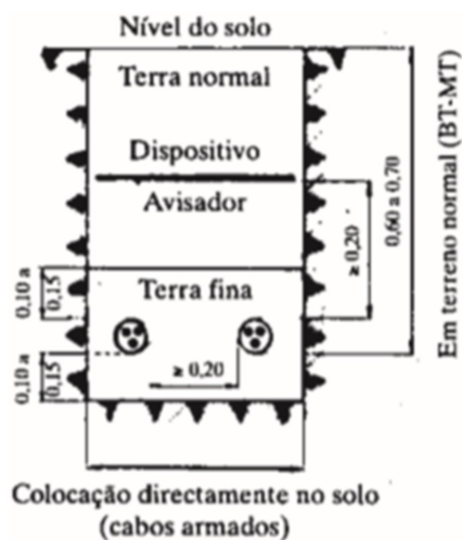
Figura 9 - Cabo enterrado directamente no solo. [10]
