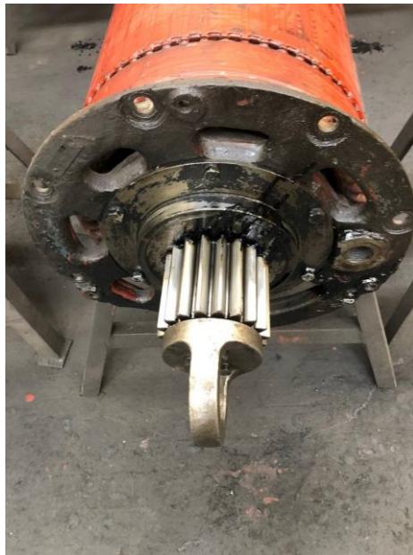
Figura 5: Montagem do pinhão no veio (fonte: elaborado pelo autor)
