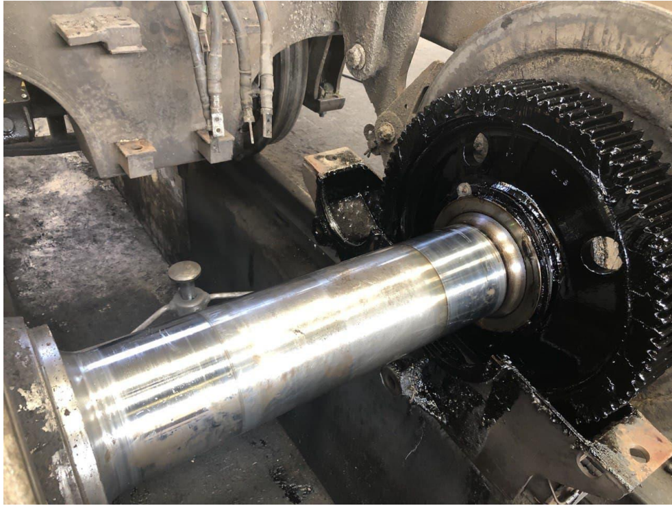
Figura 19: Veio do rodado que ilustra contaminação da massa lubrificante no casquilho (fonte: elaborado pelo autor)
