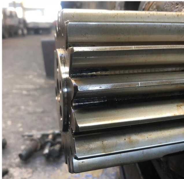
Figura 16: Montagem incorrecta do pinhão no veio (fonte: elaborado pelo autor)
