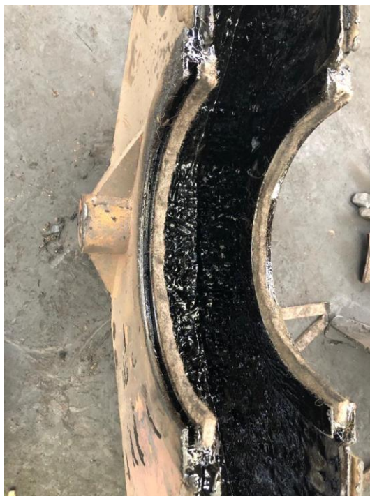
Figura 21: Montagem de vedantes na caixa de engrenagens (fonte: elaborado pelo autor)
