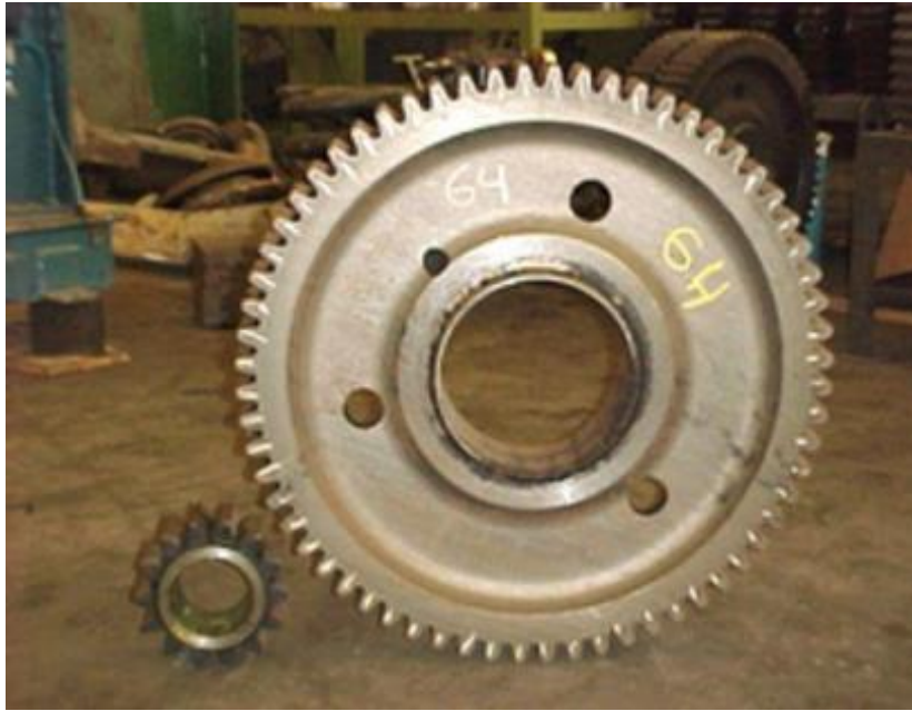
Figura 4: Engrenagens motora e movida (fonte: Borba 2011)
