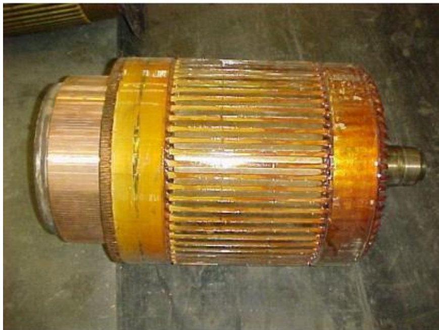
Figura 3: Armadura do motor de tracção (fonte: Dalmasco, 2010)
