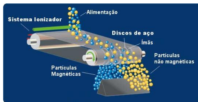
Figura 12. Esquema de funcionamento de um separador magnético de rolos
