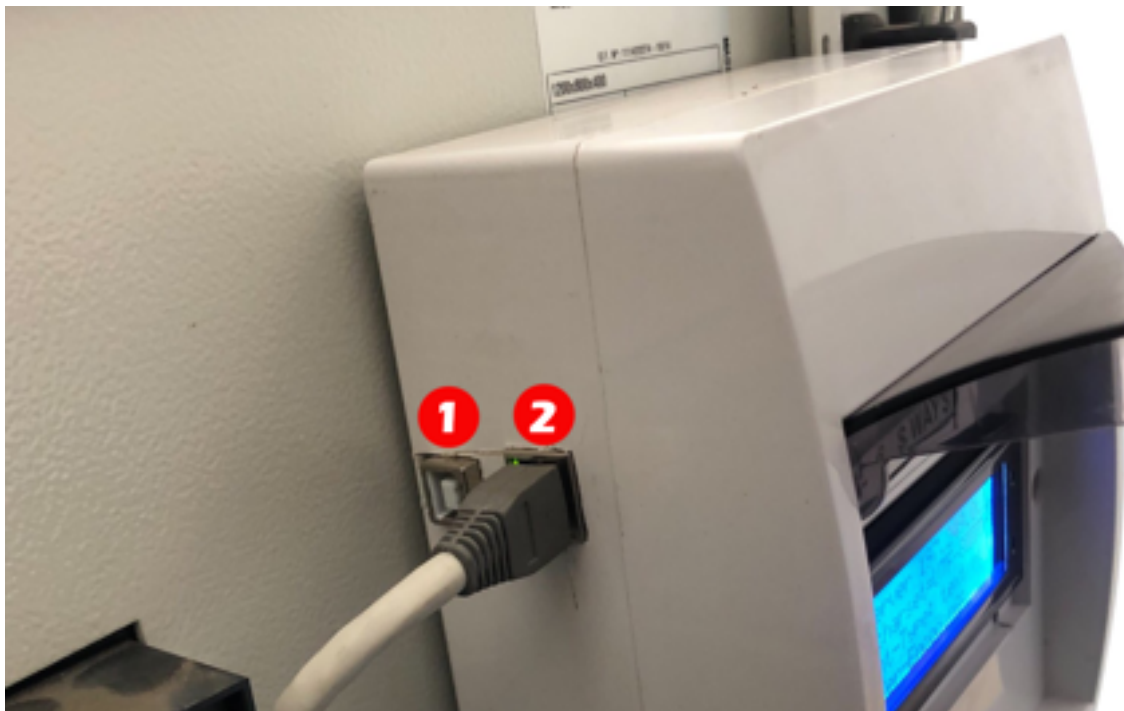
Figura 2.19: Conexão do hardware de coleta ao notebook. [Autor, 2022]
