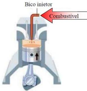
Figura 11: Injeção de combustível na massa de ar quente nos motores diesel de quatro tempos.
