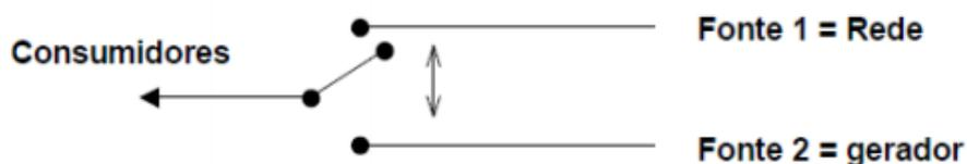
Figura 15: Conceito básico e diagrama típico de uma instalação de uma chave comutadora de um GMG.
