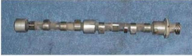
Figura 5: Partes de um motor a diesel, comando de válvula.
