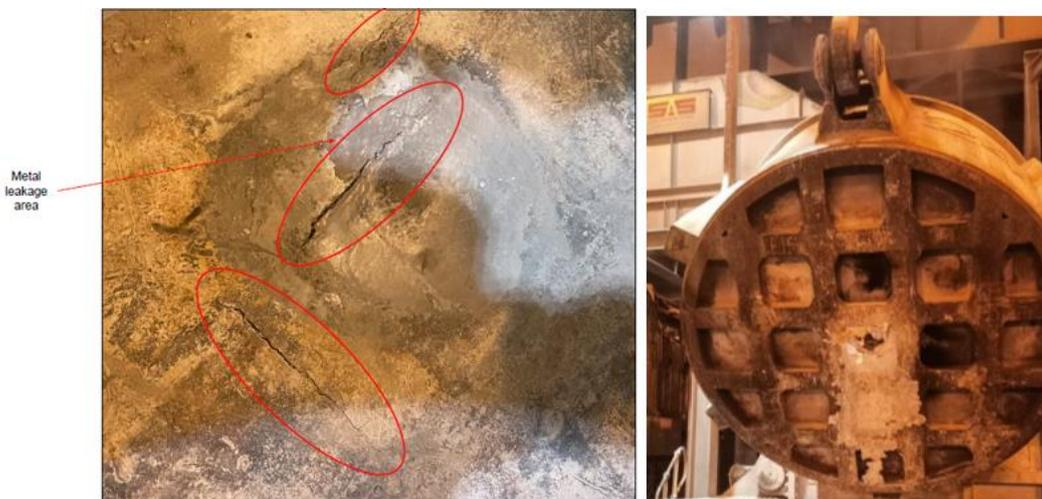
*Figura 3. 2: Vazamento de alumínio pela base do metal ladle*
