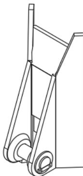
*Figura 2. 7: Representação de um lifting point*
