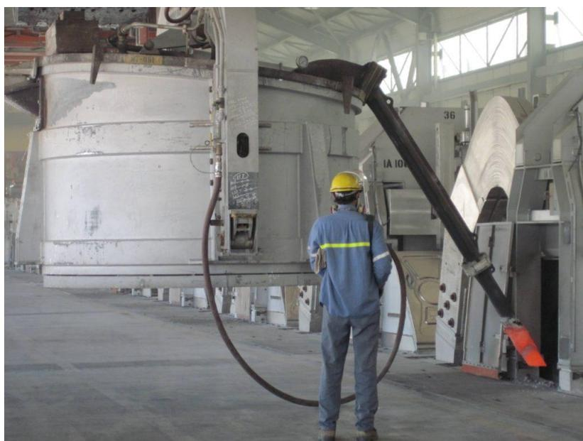
*Figura 1. 5: Processo de sucção do alumínio líquido*
