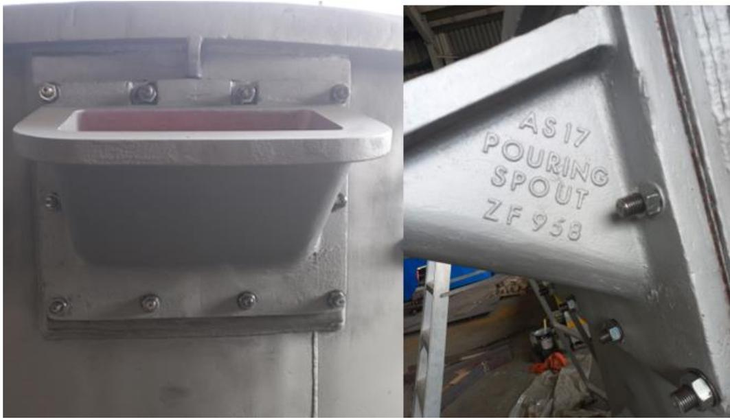
*Figura 2. 14: Ilustração do Spout fixo no metal ladle*
