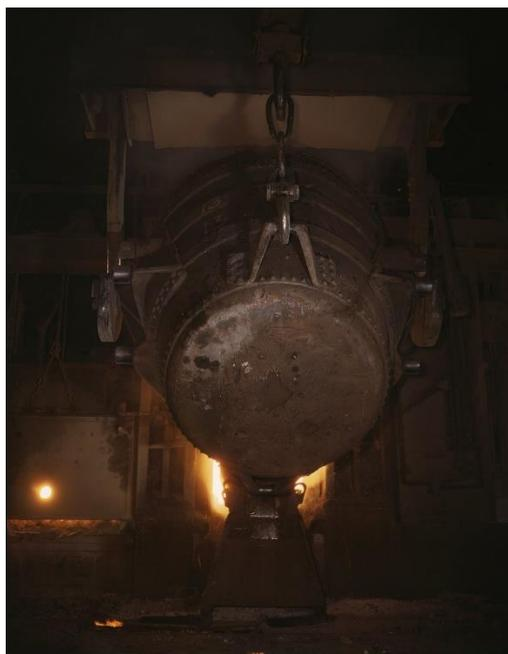
*Figura 1. 1: Ilustração de um metal ladle na posição de depósito do metal no forno*
