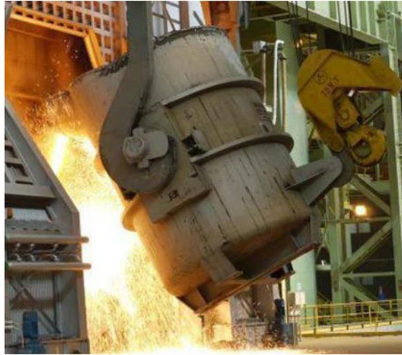
*Figura 2. 8: Demonstração do uso do lifting point*
