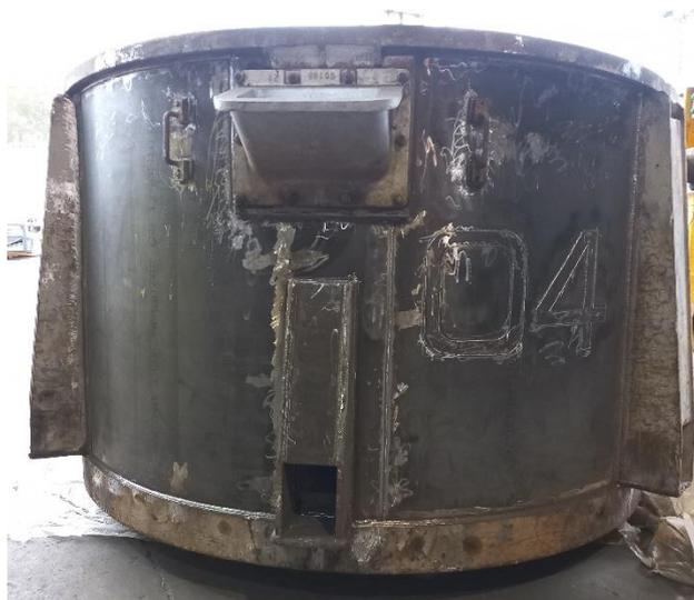
*Figura 5. 4: Chapa frontal substituída*
