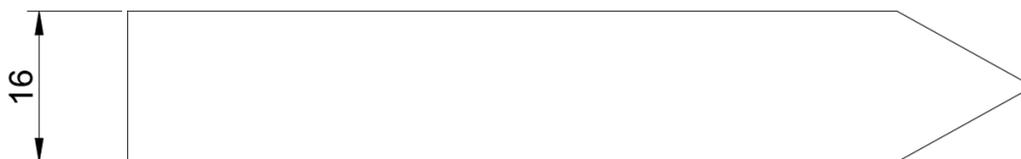
*Figura 4. 3: Representação do chanfro para a chapa de 16 mm*
