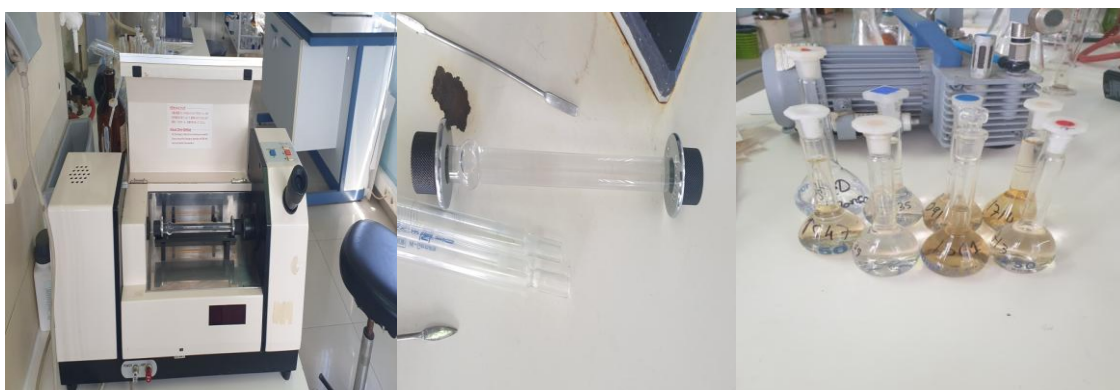
Figura 5: polarímetro (a) Tubo polarímetro (b) Solução (c)
