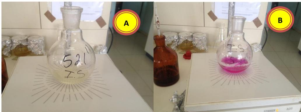
**Figura 15:** A- Balão contendo a solução amarela antes e depois da titulação, B- Balão contendo solução rosa depois da adição da fenolftaleína
