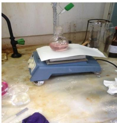
**Figura 11:** Imagem de erlenmeyer contendo uma amostra titulada com hidróxido de sódio a 0,1N.
