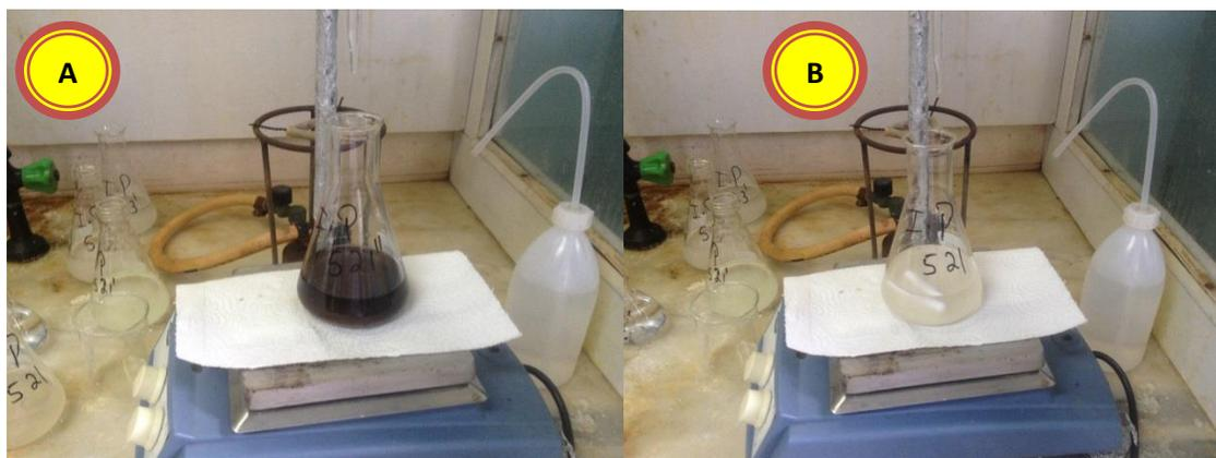
**Figura 12:** A- Erlenmeyer contendo a solução com cor azul-escura após a adição do indicador amido B- Cor amarela esbranquiçada após a titulação
