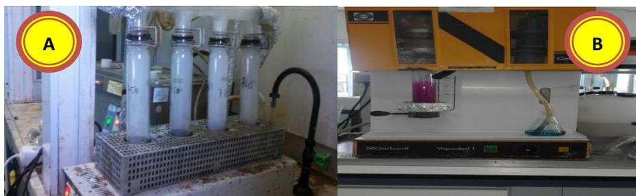
**Figura 18:** A- Imagem de um mineralizador, B- Imagem de um destilador
