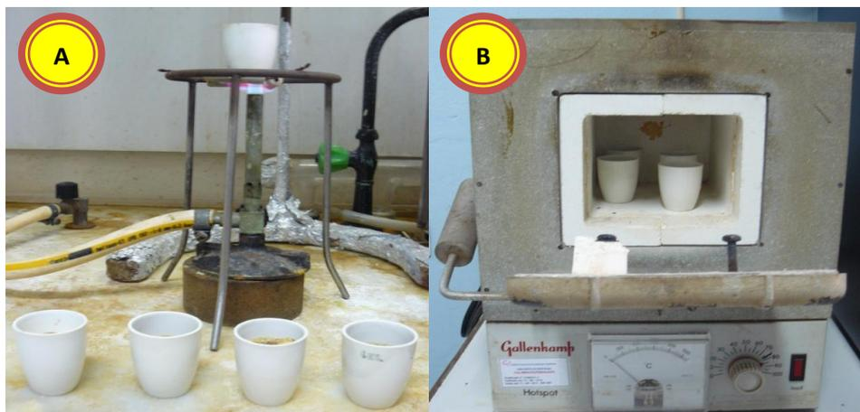
**Figura 16:** A- Carbonização no bico de Bunsen, B- Incineração na Mufla
