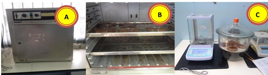
**Figura 10:** A e B- Imagem de estufa de secagem C- Imagem balança analítica e excicador
