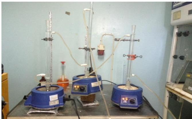
**Figura 14:** Esquema de montagem de um refrigerante para aquecimento.
