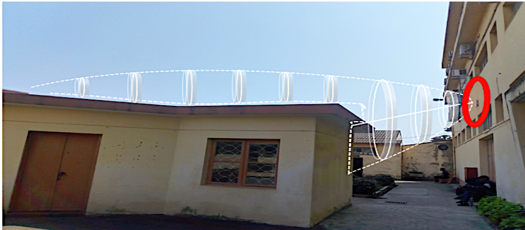
Figura 31: Estudo parcial do lóbulo principal e zona Fresnel do AP Outdoor do
