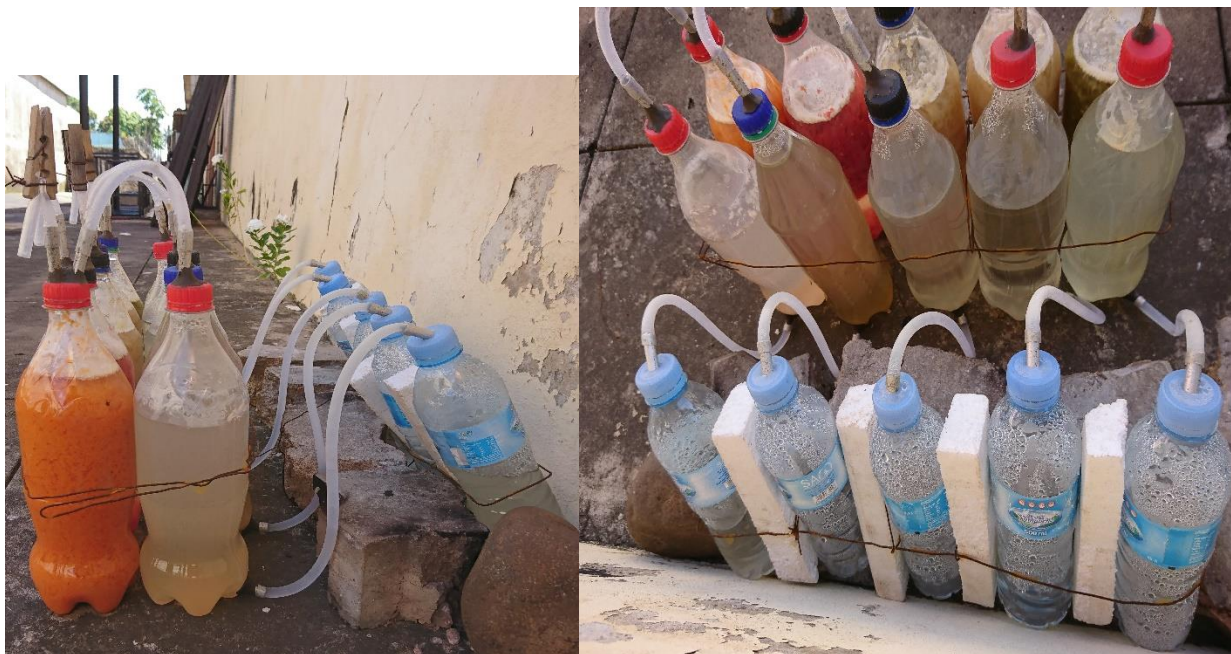
Figura 3.5 - Situação dos biodigestores após 14 dias de operação.
