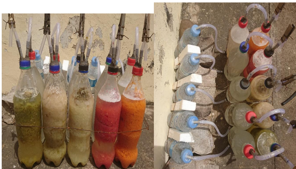
Figura 3.4 - Situação dos biodigestores após 6 dias de operação.
