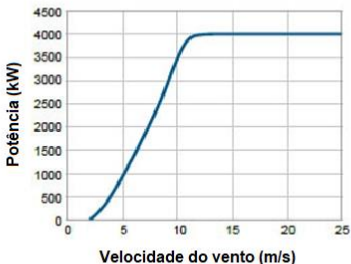
Figura 3.9. Características operacionais (Potência x Velocidade do vento) da Turbina.
