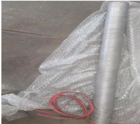
Figura12: Ânodo de ferro-fundido
