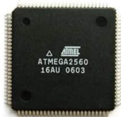
Figura 7: Microcontrolador ATmega2560. Fonte: (Marquez, 2007).
