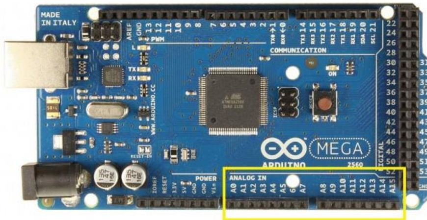
Figura 11: Pinos de entradas Analógicas. Fonte: (Somera, 2007).
