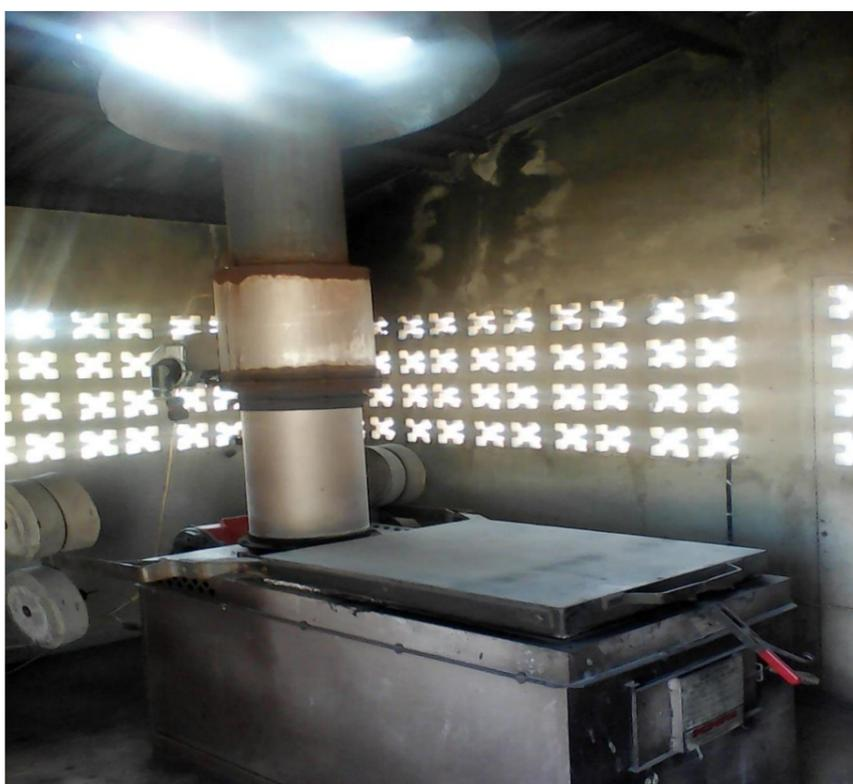
Figura 2.3.: Incineradora dos resíduos
