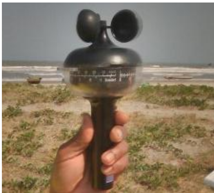
Figura 11. Ilustração do Anemómetro usado medindo a velocidade do vento
