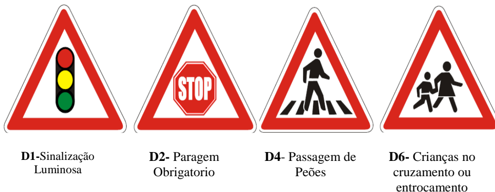
Figura 7: Sinais de Perigo.
