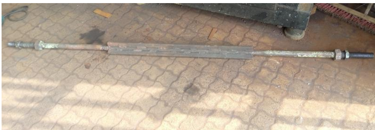
Anexo 8: Barra unida por soldadura após romper por flexão
