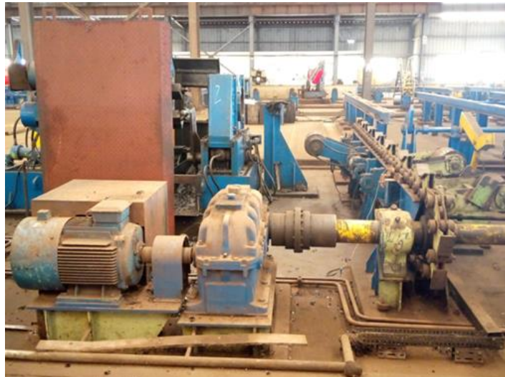
Figura 3.7: Sistema de chanfragem de tubos da Capital Star Steel
