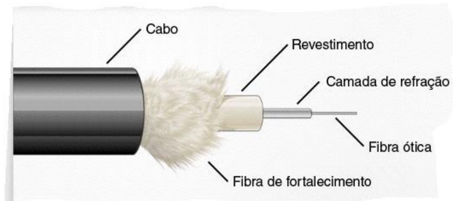
Figura 4: Composição de um Cabo de Fibra Óptica (Fonte: Introdução a Redes de Computadores, Meios de Transmissão, p.25)
