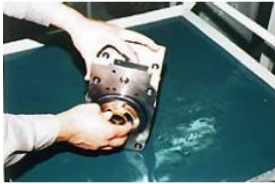
Figura 31 Placa de pressão inserida na bomba hidráulica
