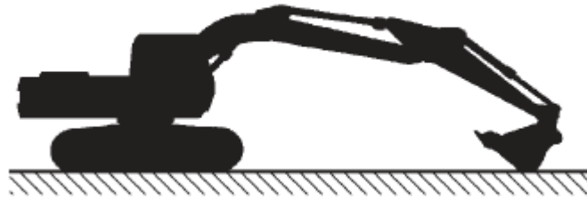
Figura 18 Escavadora de rastros
