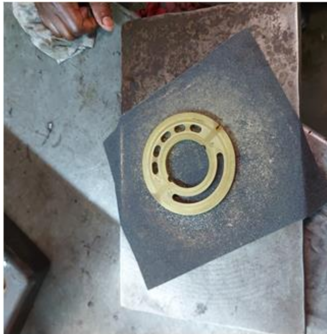
Figura 32 Placa de pressão danificada
