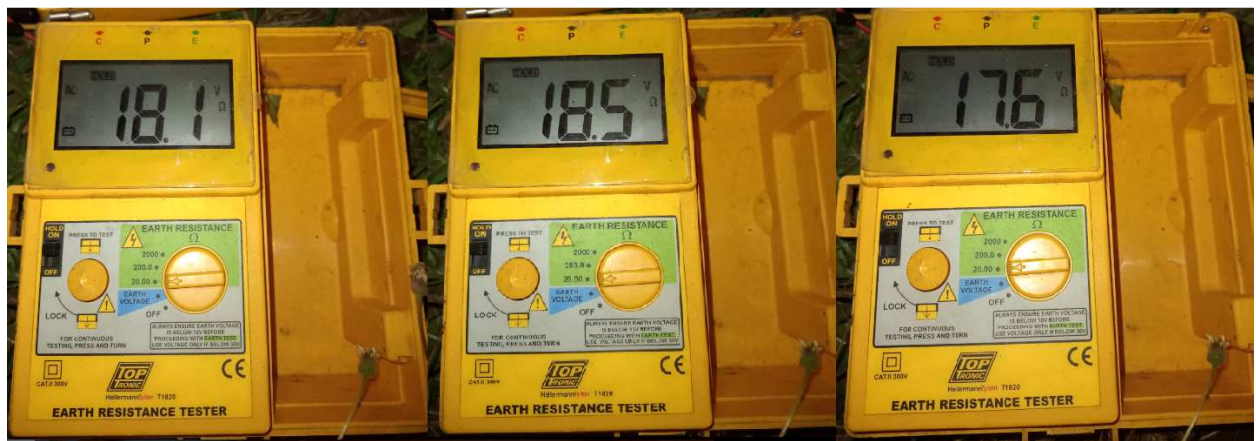
Figura 17: Medição de aterramento com espaçamento 4
