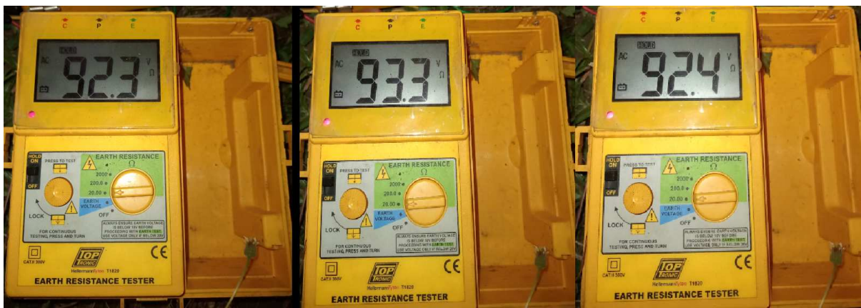
Figura 14: Medição de aterramento com espaçamento 1
