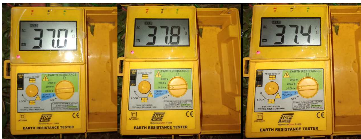
Figura 15: Medição de aterramento com espaçamento 2
