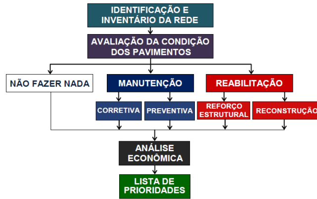
Figura 5: Fluxograma com o funcionamento de um SGP. Fonte: MAPC, 1986 apud FERNANDES JR. et al, 1999.
