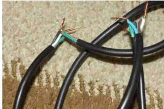
Figura 8. Emendas em fios sem projecções recomendadas [06].
