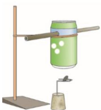
Figura 2. Esquema do calorímetro caseiro
