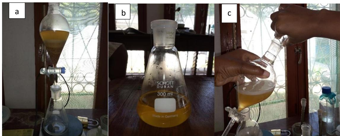
Figura 9. Filtração (a), lípidos filtrados (b), adição do KCl e separação de fases (c)
