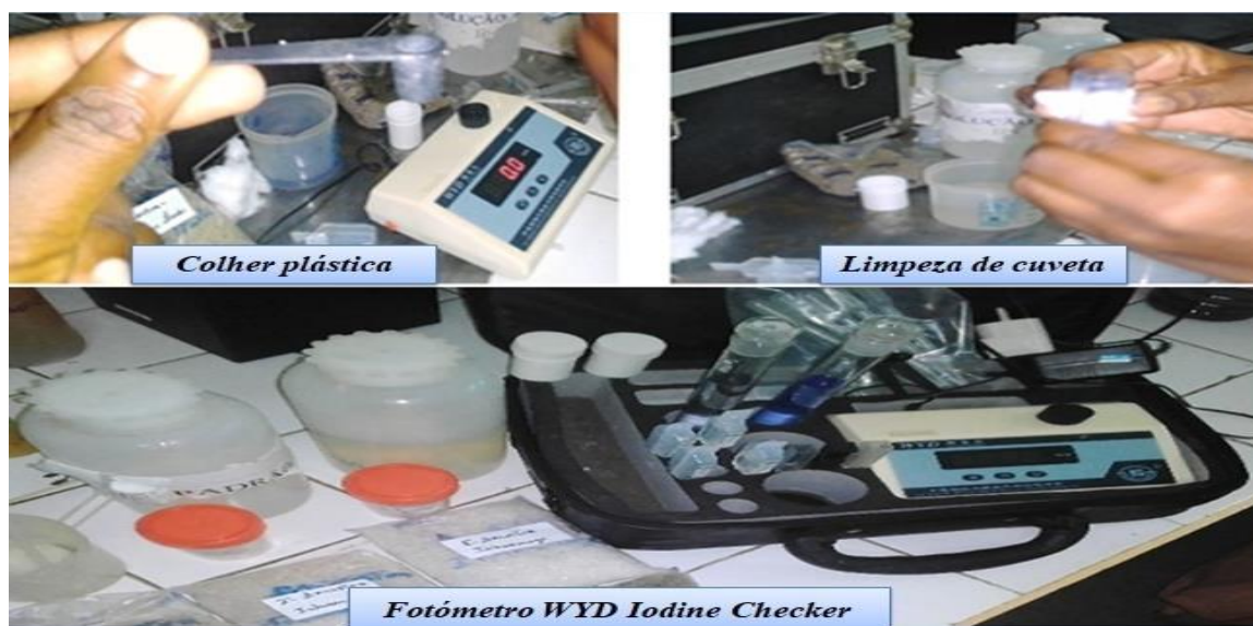
Ilustração 3: Instrumento Checker - seus materiais, reagentes, colher plástica e limpeza de cuveta antes de colocar no instrumento – 2017.
