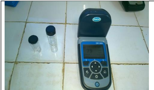
Figura 3. Fotômetro HACH DR 900
