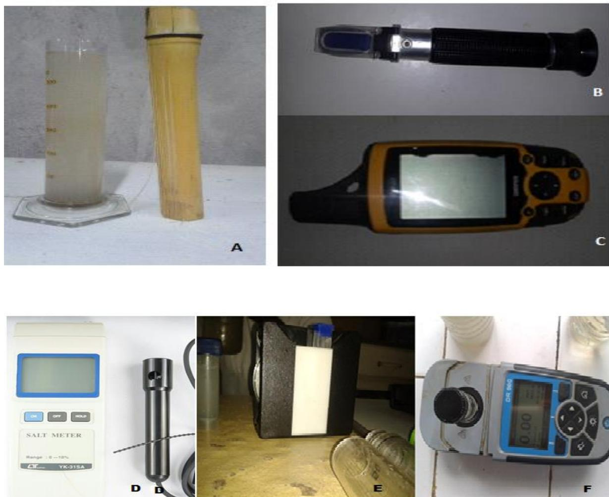
Figura 6: A figura ilustra fotografias de alguns instrumentos usados nesta pesquisa: **A** temos o bambu e a água antes da dessalinização; **B** esta ilustrado o refratometro; **C** o GPS; **D** o medidor de salinidade; **E** o Kit para medição de compostos nitrogenados; e **F** o multi-parâmetros.
