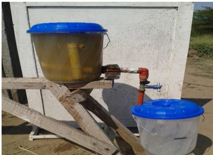
Figura 5: Fotografia ilustrando o dessalinizador de água de bambu em funcionamento, o (balde 1) superior contendo no seu interior água do poço e bambu enquanto o (balde 2) em baixo esta vazio.
