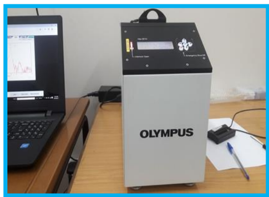
Figura 4. Difratômetro de raios-X marca Olympus , modelo BTXII, resolução 0,25 graus em função de ângulos 2\theta com o seu respectivo porta-amostra, usado para análises mineralógicas.
