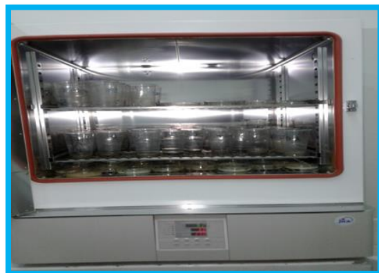
Figura 2. Amostras submetidas a ataques para a eliminação de impurezas e estufa para secar.
