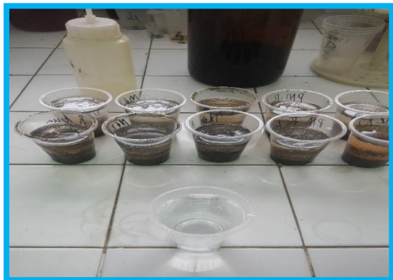
Figura 2. Amostras submetidas a ataques para a eliminação de impurezas e estufa para secar.
