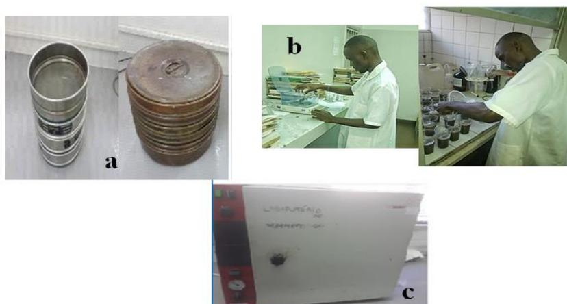
Figure 4: Materiais utilizados para a Crivagem (a); Pipetagem (b) e Secagem (c)
