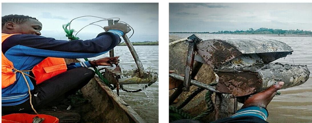
**Figura 3:** Colecta das amostras usando amostrador superficial do fundo do tipo Van-Veen no canal do Estuário de Macuse.
