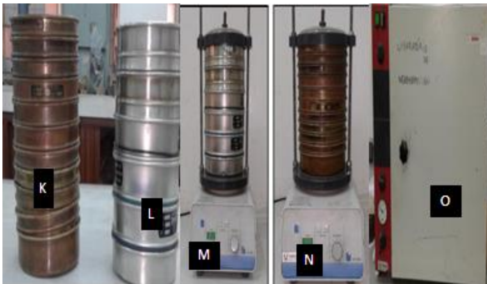
Figura 5: III) A letra (K) e (L) Peneiras granulométricas (U. S Standard Sieve), a letra (M) e (N) Peneiramento de sedimentos pelo vibrador e a letra (O) Estufa (TAMSON).
