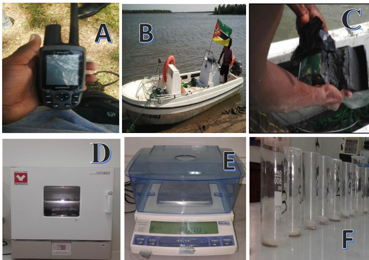
Figura 2: A) GPS, B) Barco, C) Amostrador do fundo do tipo Van Venn, D) Estufa, E) Balança Analítica, F) Bequer.
