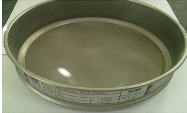
Figura 15. Peneiro normalizado com malha de abertura de 90 \mu m.
