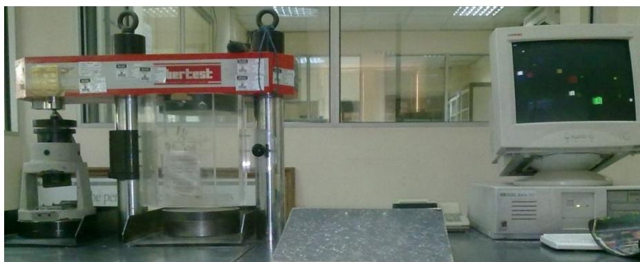
Figura 14. Aparelho para determinação de resistência a flexão e compressão.
