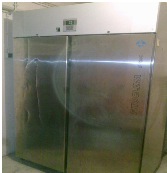
Figura 13. Aparelho para conservação de provetes em água de marca FITOCLIMA D1200.
