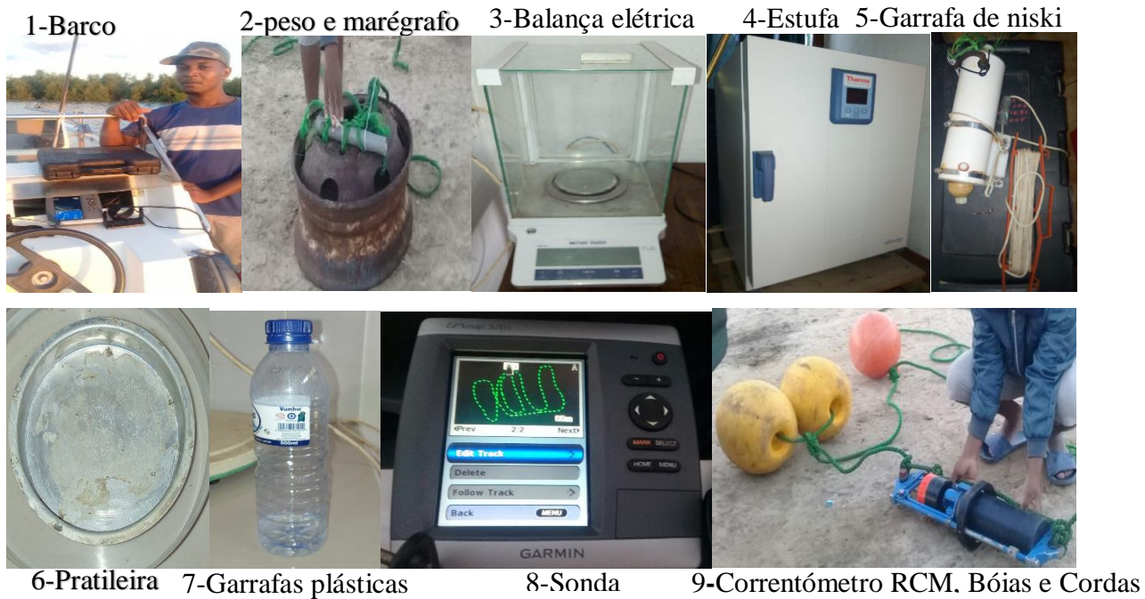
Figura 5: Ilustração de alguns instrumentos usados no campo e para o processamento dos dados.
