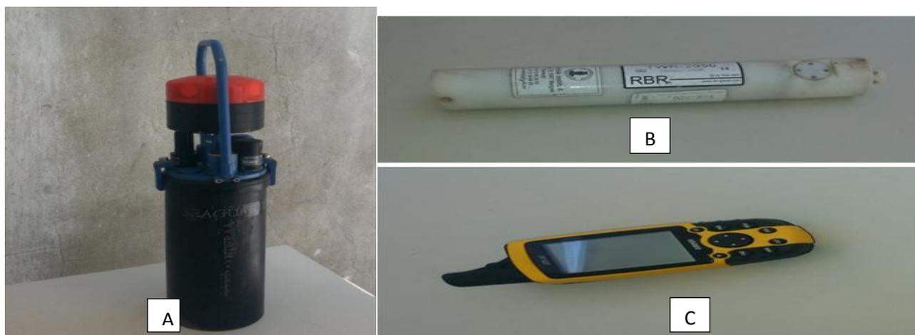
figura 5. instrumentos usados na recolha de dados , (a) correntometro Seaguard, (b) marregrafo e (c) GPS
