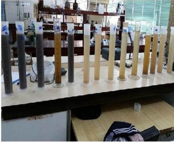
Fig36: Método de pipetagem (Provetas)
